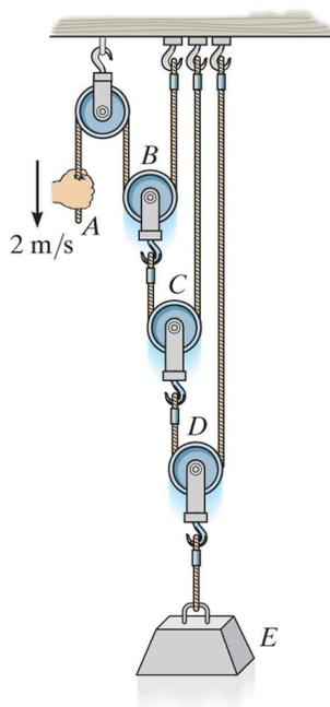
*Il y a un facteur 2 entre A et B, entre B et C, et entre C et D, donc un facteur 8 entre A et E.*
