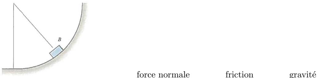
(c) La barre circulaire **rugueuse** tourne **autour de l'axe vertical  $AB$** . La masse  $m$  **reste au repos par rapport à la barre circulaire**. Considérez la masse  $m$  comme la particule, à la position illustrée.
