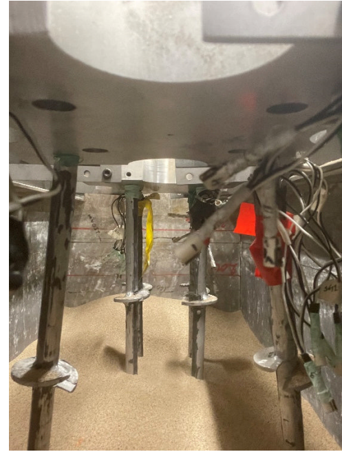
(d) Side view of ongoing pluviation with sand filling
